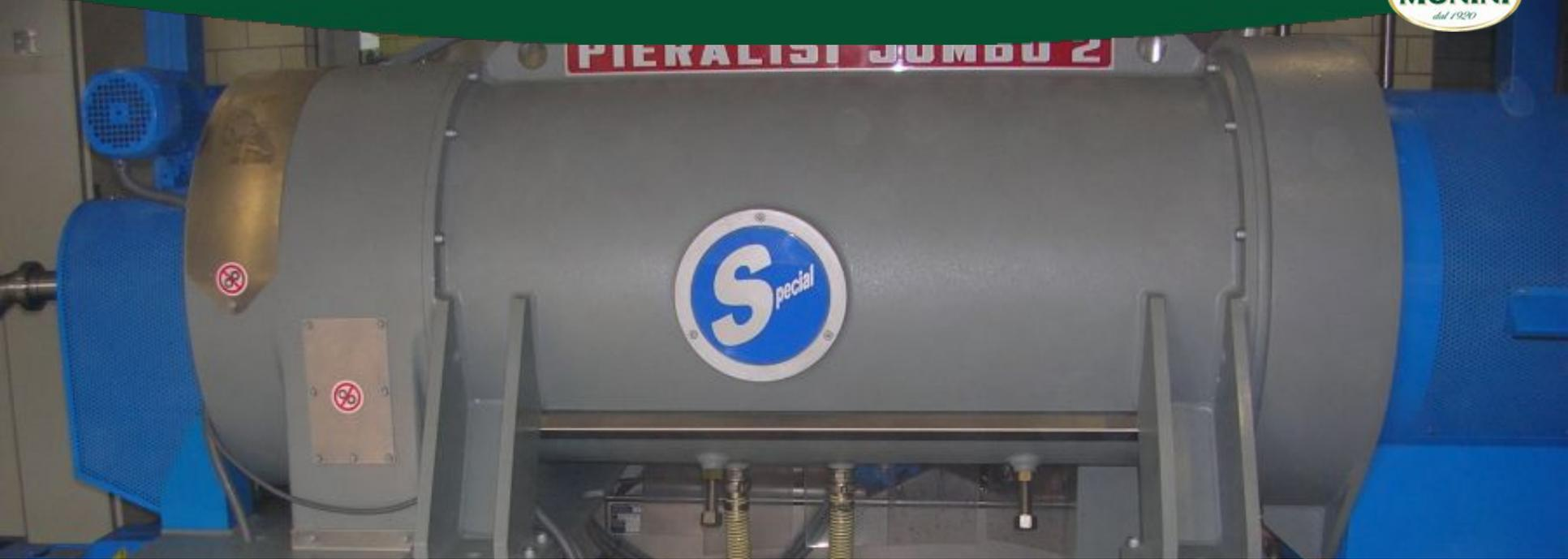
Il decanter ruotando a 3350 rpm separa istantaneamente l'olio dall'acqua di vegetazione e dalla sansa
